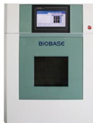
Il sistema di **digestione a microonde Series BMD** offre qualità ad un prezzo eccezionale. E' la soluzione efficace e sicura per mineralizzare campioni impiegando le microonde ed accelerare la velocità di digestione in condizioni di alta pressione. Camera da 58 o 72 litri per ospitare da 10 a 40 vessels in Teflon da 70 o 100 ml. Temp.: 300°C. Max. Pressure fino a 15 Mpa. Display "8" TFT-LED touch screen. Microwave Power: fino a 2800W. Disponibile per test presso i nostri laboratori.
